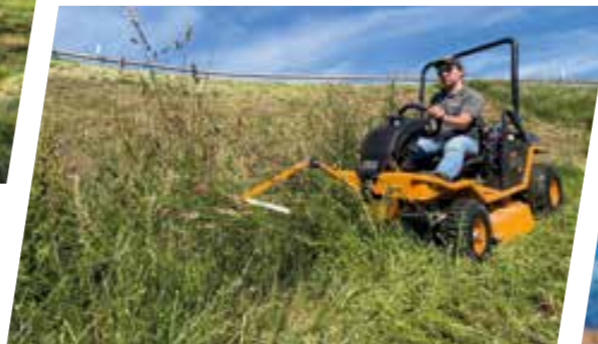
Insektenschonendes Mähen mit Scheuchvorrichtung
