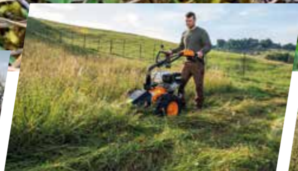
Schonender Schnitt mit Doppelmesser-Mähbalken
